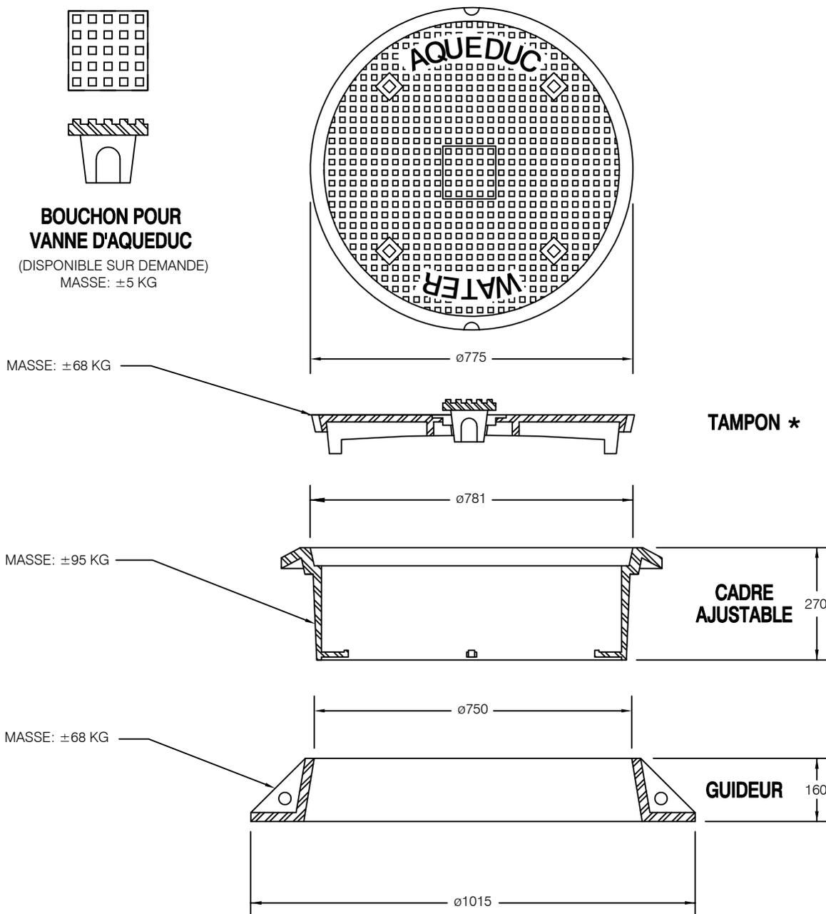
**N.B.:** LA MASSE DES GUIDEURS, CADRES AJUSTABLES ET TAMPONS DE MÊME QUE LES DIMENSIONS SONT APPROXIMATIVES ET PEUVENT VARIER SELON LE MANUFACTURIER.
