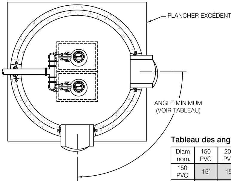
**Tableau des angles minimums entre deux raccordements**
