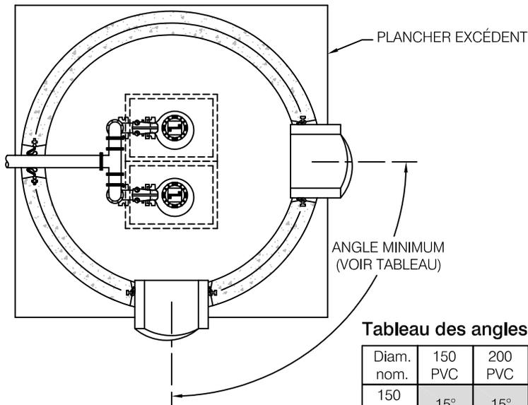
**Tableau des angles minimums entre deux raccordements**
