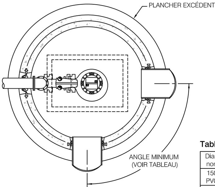
**Tableau des angles minimums entre deux raccordements en PVC**
