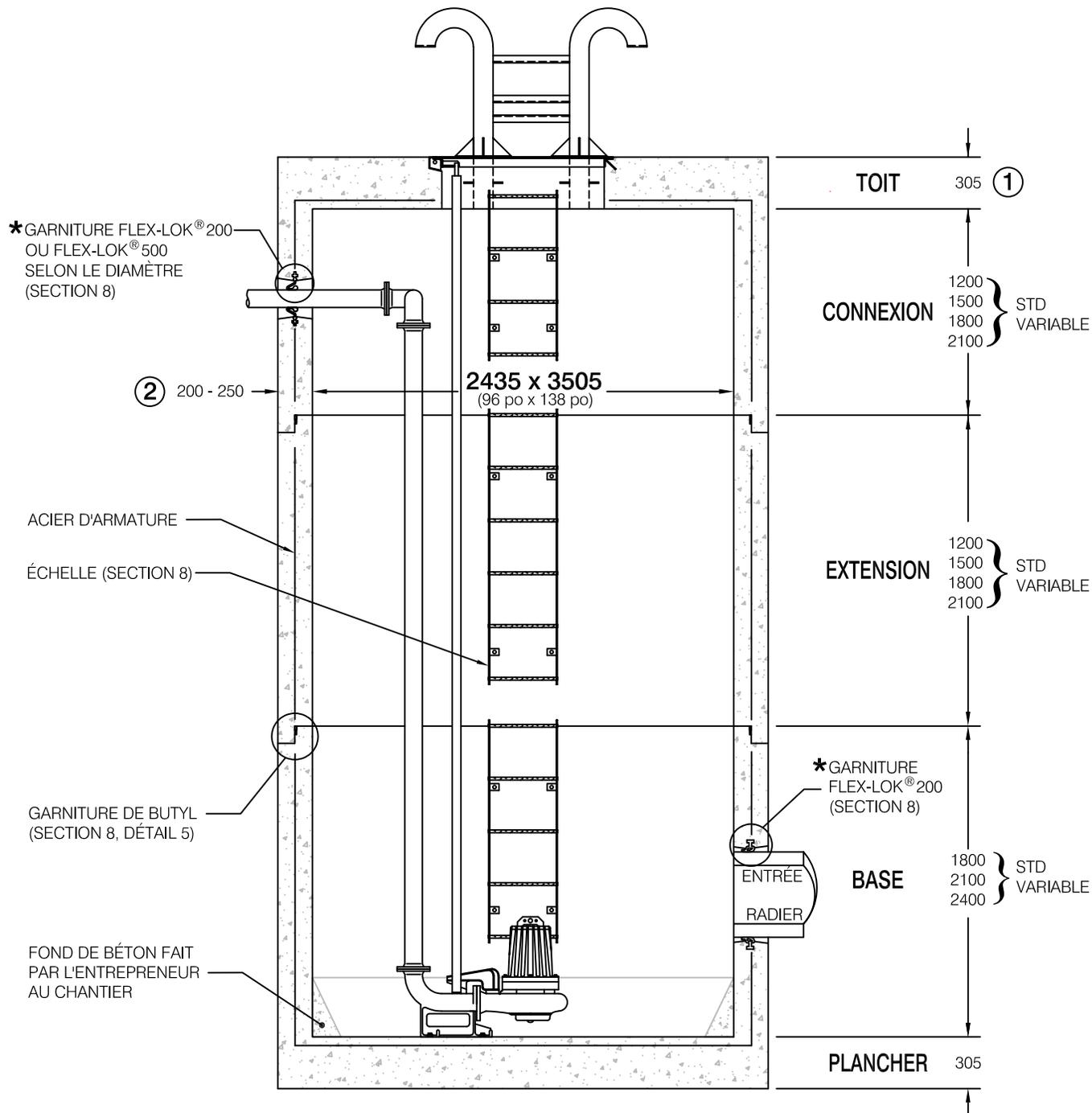
**-Station de pompage préfabriquée en béton armé conforme aux normes: BNQ 2622-420 et BNQ 1809-300.**
