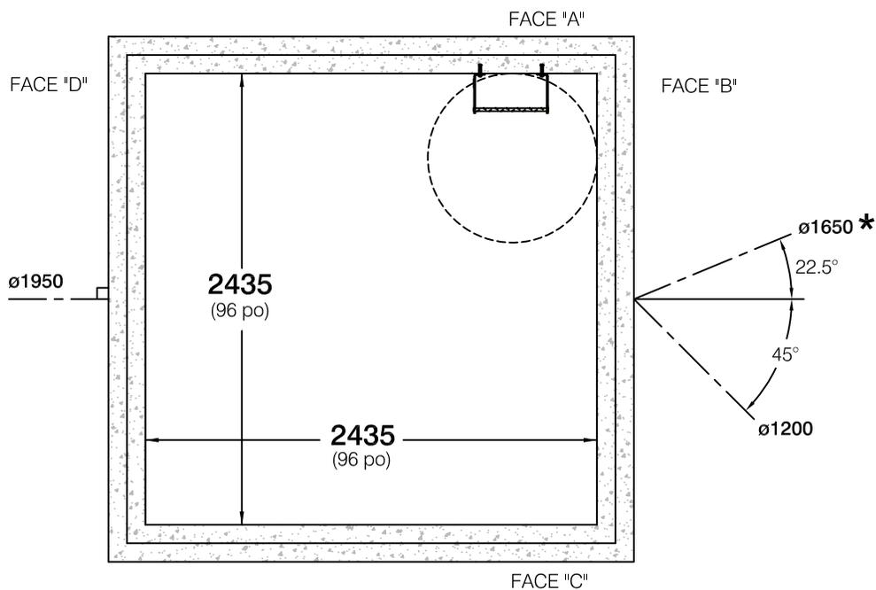
**\* NOTE IMPORTANTE:** POUR LES RACCORDEMENTS NÉCESSITANTS LA COUPE DES CONDUITES DE  $\varnothing 1350$  ET PLUS, L'UTILISATION D'UN REGARD ANGULAIRE EST FORTEMENT RECOMMANDÉE. VEUILLEZ CONSULTER NOTRE DÉPARTEMENT TECHNIQUE POUR PLUS D'INFORMATIONS.
