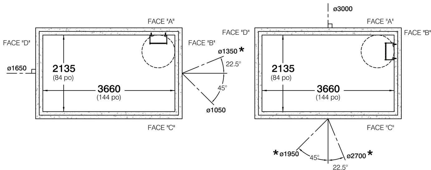
**\* NOTE IMPORTANTE:** POUR LES RACCORDEMENTS NÉCESSITANTS LA COUPE DES CONDUITES DE  $\varnothing 1350$  ET PLUS, L'UTILISATION D'UN REGARD ANGULAIRE EST FORTEMENT RECOMMANDÉE. VEUILLEZ CONSULTER NOTRE DÉPARTEMENT TECHNIQUE POUR PLUS D'INFORMATIONS.
