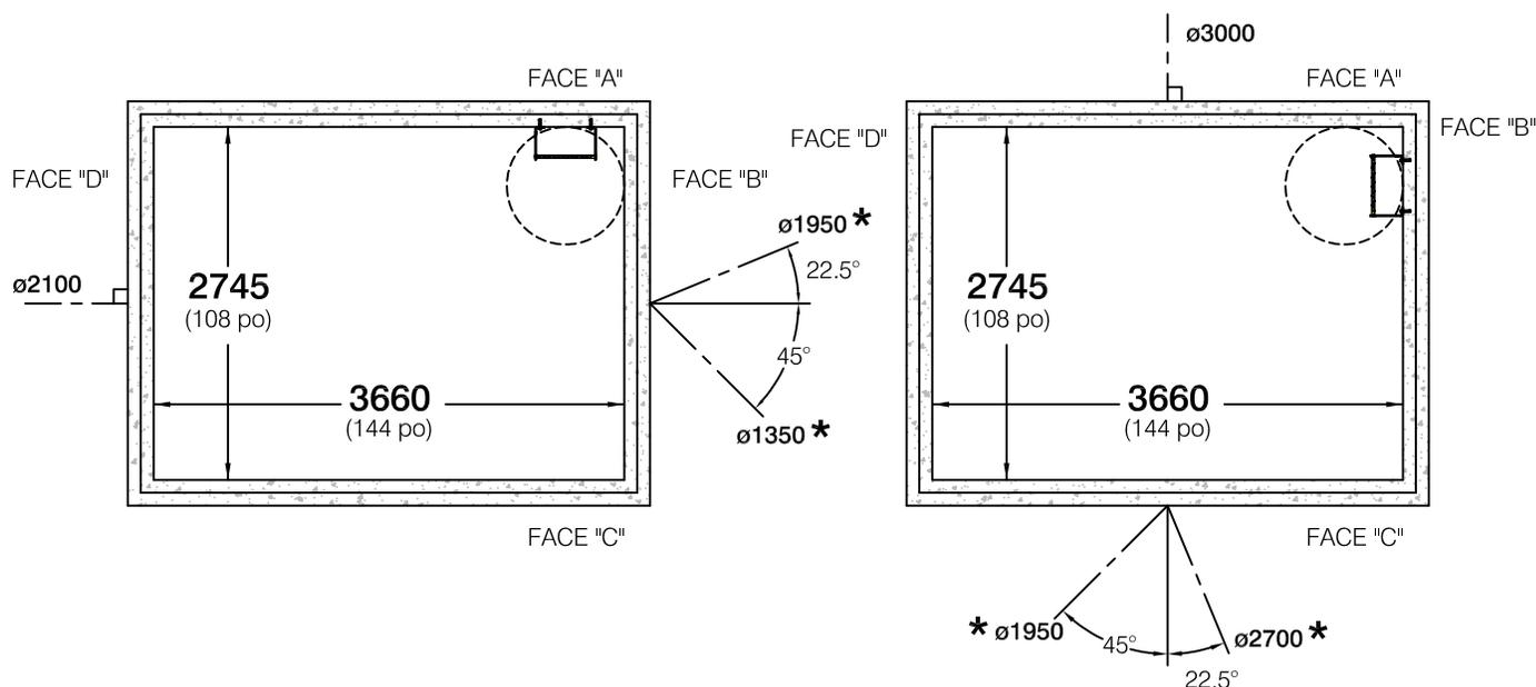
**\* NOTE IMPORTANTE:** POUR LES RACCORDEMENTS NÉCESSITANTS LA COUPE DES CONDUITES DE  $\varnothing 1350$  ET PLUS, L'UTILISATION D'UN REGARD ANGULAIRE EST FORTEMENT RECOMMANDÉE. VEUILLEZ CONSULTER NOTRE DÉPARTEMENT TECHNIQUE POUR PLUS D'INFORMATIONS.
