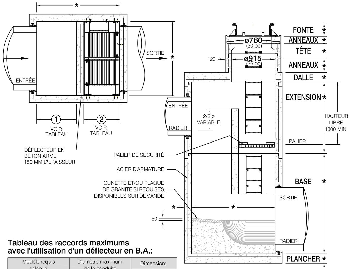
**Tableau des raccords maximums avec l'utilisation d'un déflecteur en B.A.:**
