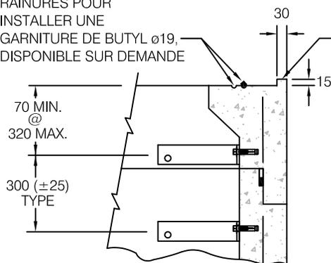
**Option 2: Anneau d'ajustement  $\varnothing 760$  plat sur les deux côtés**
