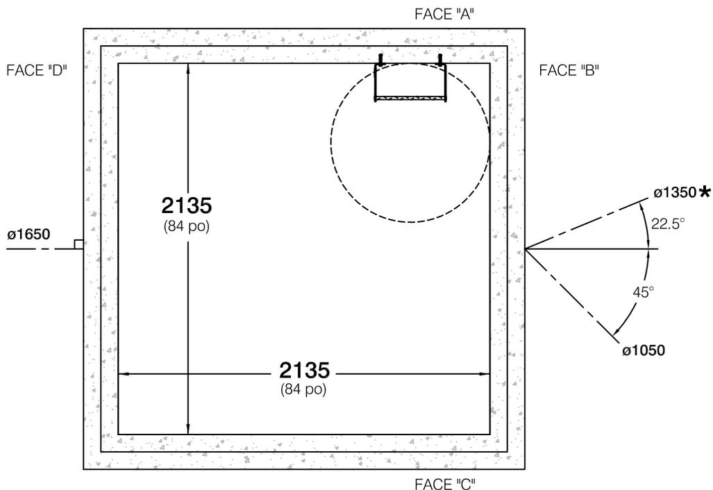
**\* NOTE IMPORTANTE:** POUR LES RACCORDEMENTS NÉCESSITANTS LA COUPE DES CONDUITES DE  $\varnothing 1350$  ET PLUS, L'UTILISATION D'UN REGARD ANGULAIRE EST FORTEMENT RECOMMANDÉE. VEUILLEZ CONSULTER NOTRE DÉPARTEMENT TECHNIQUE POUR PLUS D'INFORMATIONS.
