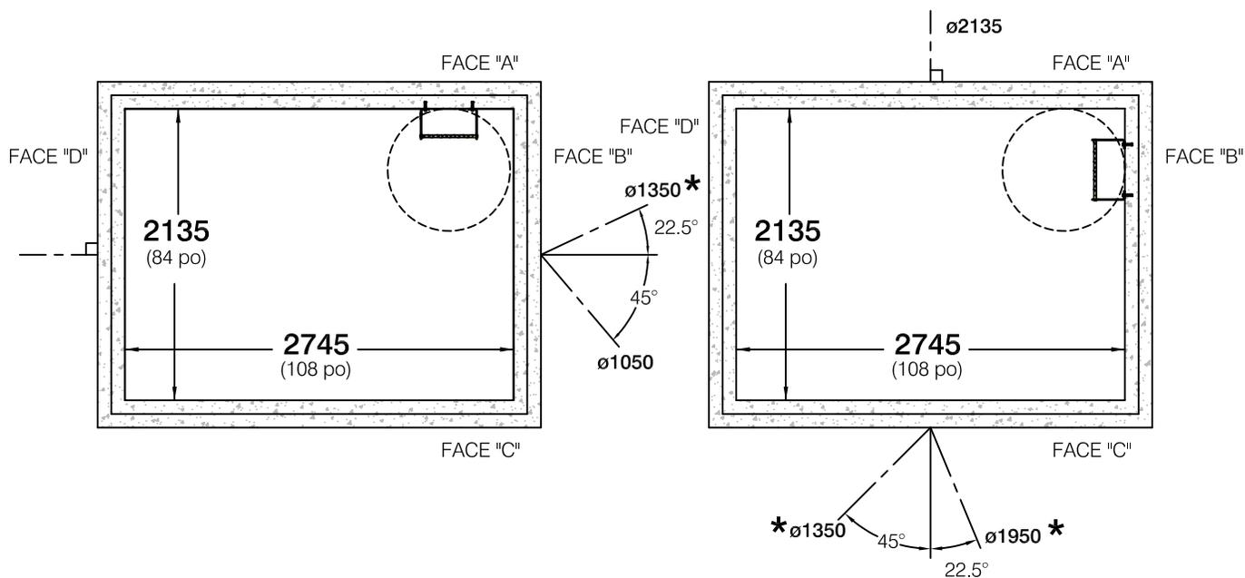
**\* NOTE IMPORTANTE:** POUR LES RACCORDEMENTS NÉCESSITANTS LA COUPE DES CONDUITES DE  $\varnothing 1350$  ET PLUS, L'UTILISATION D'UN REGARD ANGULAIRE EST FORTEMENT RECOMMANDÉE. VEUILLEZ CONSULTER NOTRE DÉPARTEMENT TECHNIQUE POUR PLUS D'INFORMATIONS.
