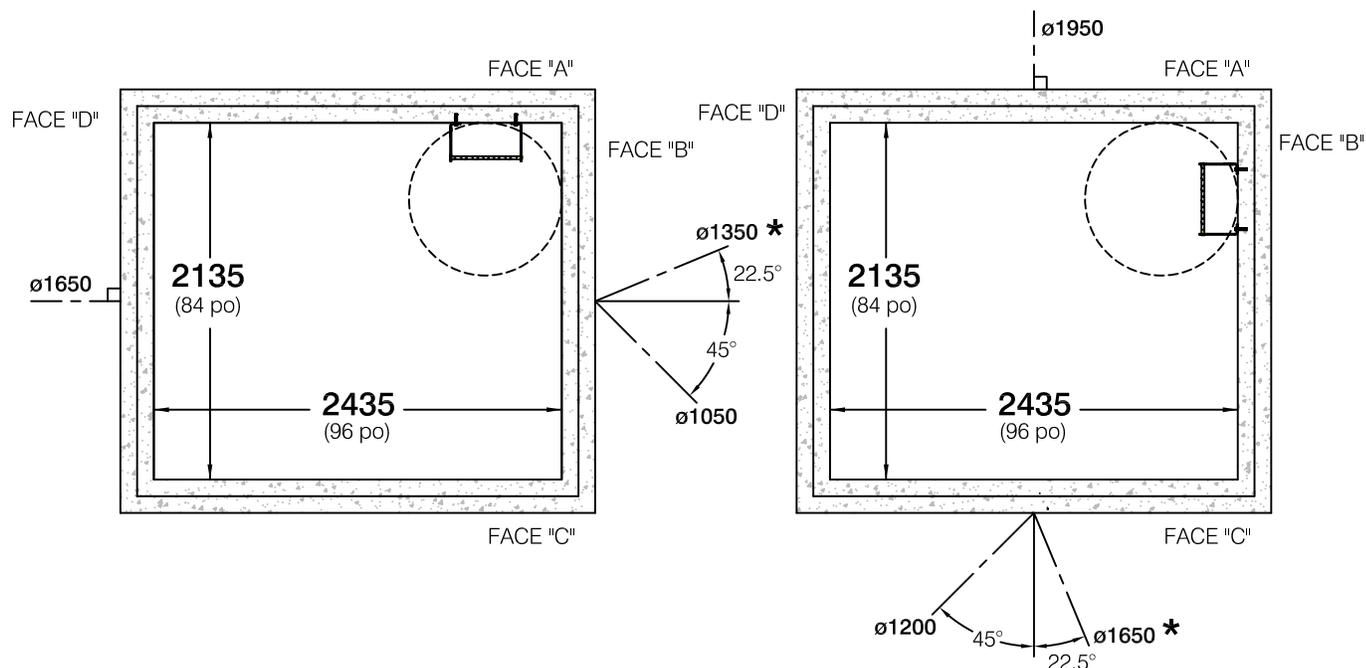
**\* NOTE IMPORTANTE:** POUR LES RACCORDEMENTS NÉCESSITANTS LA COUPE DES CONDUITES DE  $\varnothing 1350$  ET PLUS, L'UTILISATION D'UN REGARD ANGULAIRE EST FORTEMENT RECOMMANDÉE. VEUILLEZ CONSULTER NOTRE DÉPARTEMENT TECHNIQUE POUR PLUS D'INFORMATIONS.
